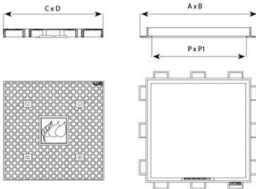
Realizada en fundición dúctil, en gráfico esferoidal, según ISO 1083 (Tipo 500-7) y norma EN 1563
