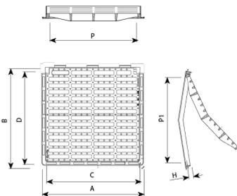
Cóncava está diseñada para soportar un tráfico suave. Perfecta para instalar en vías con una IMD de 500 a 1.000, especialmente en arcenes y cunetas.
