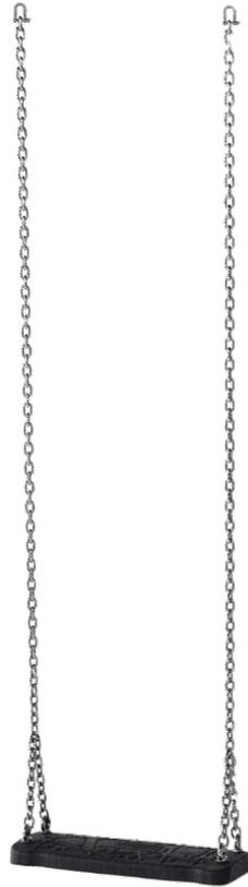
Materialien: Der Brettsitz wird aus TPE-Druckguss hergestellt (Elastomer-Kunststoff mit Aluminiumverstärkung). Schaukelkette mit Schäkkel am oberen Ende. Ketten aus Edelstahl (Ø 5 mm) Länge 1,70m, werden mitgeliefert. Farbe: Schwarz Abmessungen: 450x180x38,5mm
