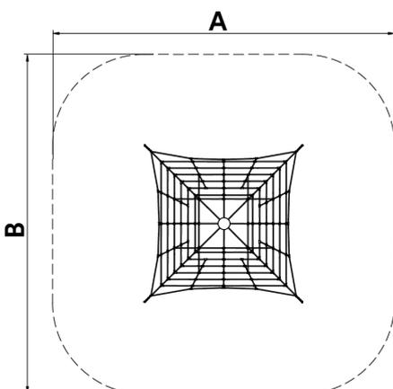
Struktur, Metall: Zentralmast, grundlegender Teil des Gerätes, aus feuerverzinktem Stahl. Seine Funktion ist es, Schwingungen auszubalancieren und die hohen Lasten der Achsen mitzutragen.
