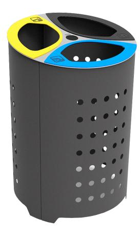
Der Abfallbehälter Doria bietet eine gute Lösung zur Mülltrennung. Integrierter Ascher. Der Behälter besteht aus 2mm Stahlblech, mit Befestigungsring. Kataphorese-Behandlung und Pulverbeschichtung in schwarz. Abdeckung aus AISI 304 mit 3 Öffnungen um zu verhindern, daß größere Müllbeutel entsorgt werden.
