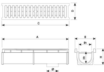
Canal + Mecalineas D4, für mittelmäßigen Verkehr geeignet. Ideal für einen durchschnittlichen täglichen Verkehr von 1.000 bis 20.000, Fahrbahnen, Fußgängerzonen, Seitenstreifen, und Parkplätze für alle Fahrzeugarten.
