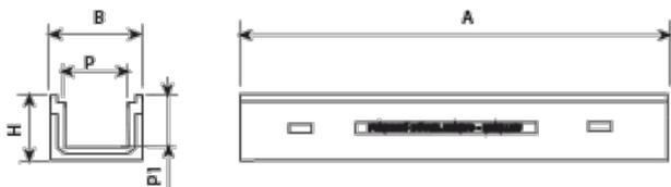
Canal HRM + Mecaline diseñada para soportar un tráfico suave. Perfecta para instalar en vías con una IMD de 500 a 1.000, especialmente en arcones y cunetas.
