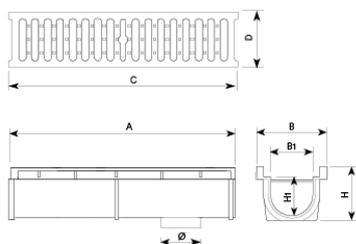
Canal + Mecalinea D4 diseñada para soportar un tráfico medio. Perfecta para instalar en vías con una IMD de 1.000-20.000, especialmente Calzadas de carreteras (incluyendo calles peatonales), arcenes estabilizados y zonas de aparcamiento para todo tipo de vehículos.
