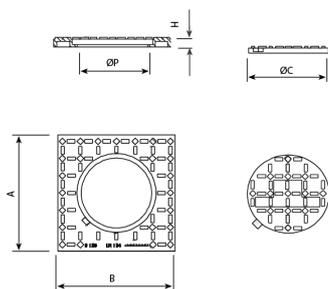
Realizada en fundición dúctil, en gráfico esferoidal, según ISO 1083 (Tipo 500-7) y norma EN 1563. Clase B-125 según EN 124. Grupo 2. Aceras, zonas peatonales y superficies similares, áreas de estacionamiento y aparcamientos de varios pisos para coches.
