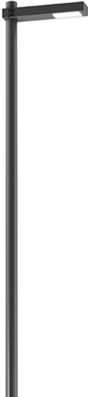
Mât en tube d'acier laminé (S235-JR) de profil rectangulaire de 200mm x 100mm. Hauteur de 4m à 7m. Possibilité d'inclure une ou deux consoles (même niveau ou différent).
