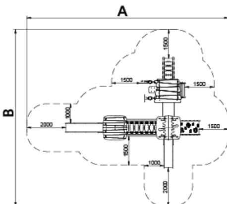
Collection de jeux pour enfants **fabriquée avec des matériaux sans entretien** : poteau extrudé en aluminium et polymère, marches en aluminium d'une seule pièce et plateformes en polymère antidérapant. L'utilisateur trouvera des jeux inclusifs sur l'ensemble de la structure.
