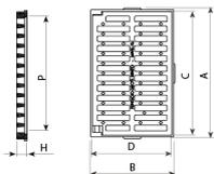
Imbornal est conçue pour supporter un trafic modéré. Idéale pour installation sur voies ayant un TMJ de < 500, notamment sur accotements et caniveaux.
