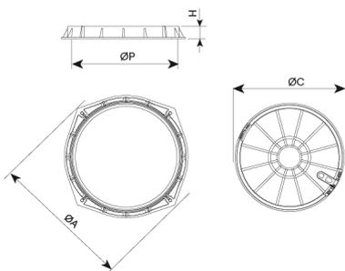
HRM D4 est conçu pour supporter un trafic modéré. Idéal pour installation sur voies ayant un TMJ de 500 à 1.000, notamment sur chaussées, accotements stabilisés et zones de stationnement pour tout type de véhicule.
