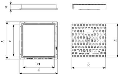
Hidráulica D4 est conçu pour supporter un trafic moyen. Idéal pour installation sur voies ayant un TMJ de 1.000 - 20.000, notamment sur chaussées, accotements stabilisés et aires de stationnement pour tout type de véhicule.
