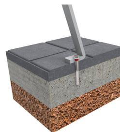
Le traitement Ferrus se compose de trois couches appliquées après le nettoyage de toutes les saletés et impuretés par grenailage et consiste en un bain électrolytique, suivi d'une couche d'apprêt époxy et d'une couche finale de peinture en poudre polyester de couleur grise RAL 9006. Ancrage recommandé : Au moyen de 4 boulons à expansion M8, en fonction de la surface et du projet.
