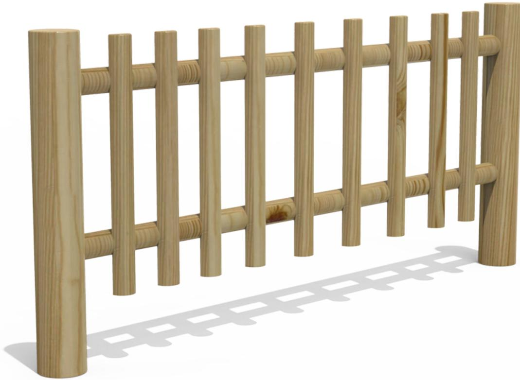
Barrière en bois de pin traitée en autoclave vide et pression classe IV contre les vrillettes, termites et insectes. Poteaux de  $\varnothing 120 \times 1500$ mm. Traverses de  $\varnothing 80 \times 2000$  mm. Barreaux demi-cercle de  $\varnothing 90$ mm.
