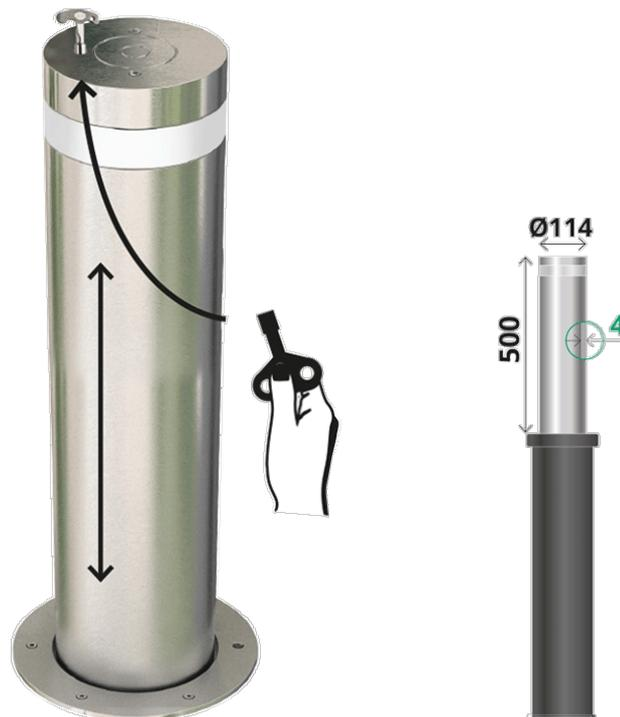
Dissuasore a scomparsa manuale realizzato con pistone in acciaio inox AISI-304 satinato Ø114 x 500 mm di altezza. Coperchio, telaio, elementi di fissaggio e viti in acciaio inossidabile. Con una fascia riflettente. Si alza automaticamente e si abbassa manualmente.
