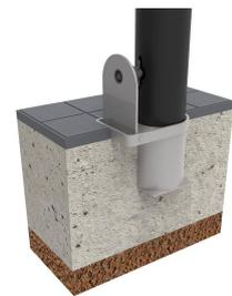
Ancoraggio raccomandato: mediante base di alloggiamento da ancorare in CLS, realizzata in acciaio zincato, munita di coperchio e di chiave.
