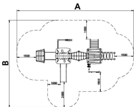
Linea di combinati realizzati con materiali esenti da manutenzione, con l'innovativo montante ad estrusione mista a base di **alluminio e polimero**, i gradini in alluminio monoblocco o le pedane in polimero antiscivolo. Una perfetta industrializzazione per una linea dove non è stato risparmiato un solo dettaglio di design e che comprende molte parti inclusive.
