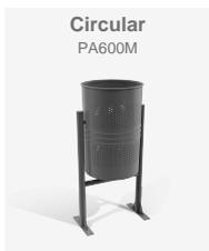
Cestino in acciaio inossidabile AISI 304 lucido realizzato con contenitore ribaltabile con due fasce di fori tondi, scatola sulla sommità. Il contenitore è ancorato a 2 basamenti realizzati in tubolare di Ø40 mm provvisti di profilati in piatto d'acciaio inox, predisposti in due fori di Ø12 mm per l'ancoraggio a terra.
