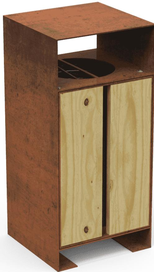
Portarifiuti realizzato con telaio in lastra di acciaio Corten con spessore 6 mm e ante con doghe di legno di pino trattato in autoclave, rischio classe IV, con protezione contro tarli, termiti ed insetti. Con cestello interno in acciaio galvanizzato.
