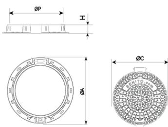
**Compart è progettato per sopportare un traffico medio.** Perfetto per essere installato su strade con un ADT di 1.000-20.000, specialmente per carreggiate stradali (incluso le vie pedonali), banchine e le aree di sosta per tutti i tipi di veicoli.
