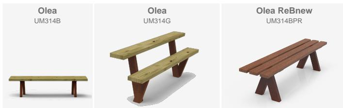
OLEA è una panchina realizzata con piedi posti a forma di "V" rovesciata in tubolari di acciaio corten 50x100 mm. Doghe di legno di pino trattato in autoclave, rischio classe IV, con sezione di 210 x 50 mm, con protezione c acciaio inossidabile.
