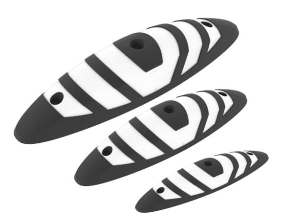
Separatore per pista ciclabile realizzato con pellet di PVC riciclato al 100%, recuperato dal rivestimento di cavi elettrici già utilizzati (POST CONSUMO). Rifinito con vernice riflettente a base di microsfere riflettenti. Ancoraggio raccomandato: mediante viti di ancoraggio A4 INOX. HIT-V-M12x150 mm - WS 9350 12x160 mm. Ancoraggio chimico. HILTI-HI-170 - Sika Anchorfix-1. Non fornito.
