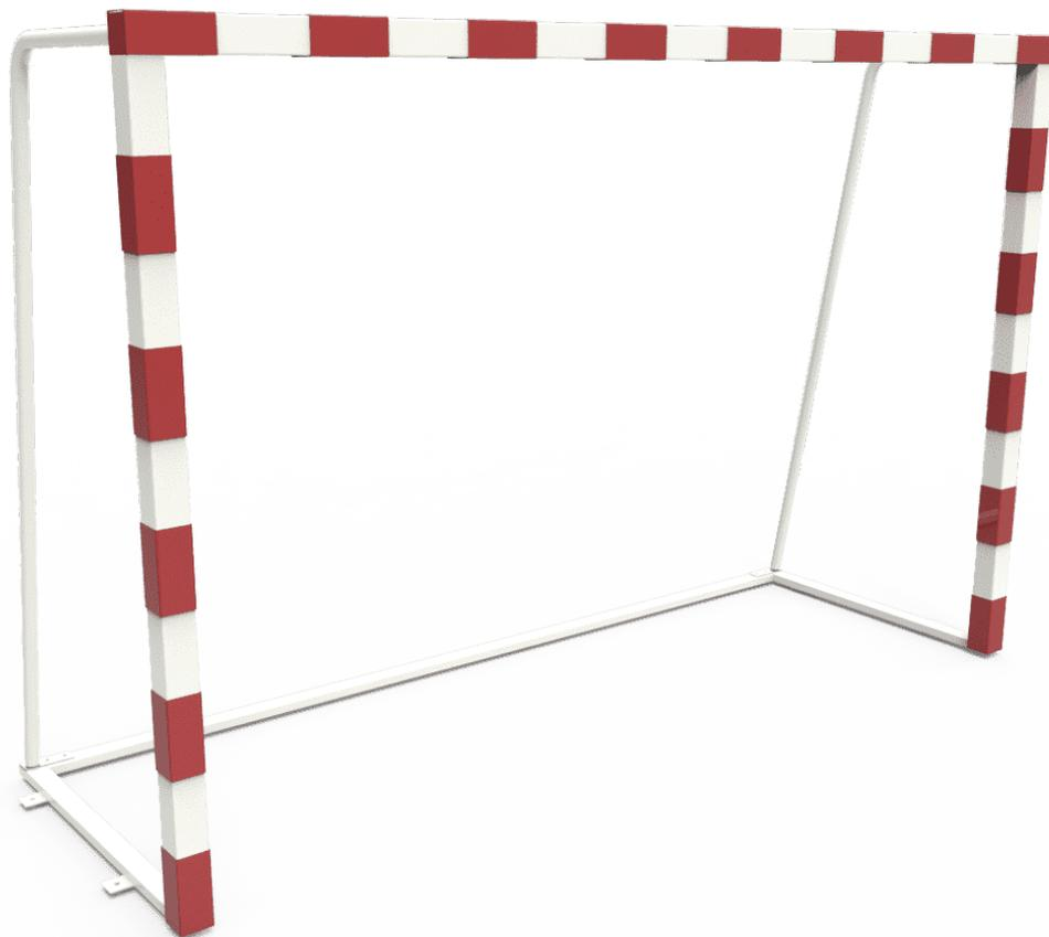
Fuß-oder Handballtor. Rahmen: Stahlrohr 80x80mm. Finish durch Entfettung, Phosphatierung und Thermolackierung in Rot (ASTM 11,757 / DIN 50015). Weiße, aufgesetzte Vinylstreifen. Netz: Aus Polyethylen- oder Olefinfäden, je nach Modell. Nicht im Lieferumfang enthalten. Hinteres Gestell: aus rundem Stahlrohr
