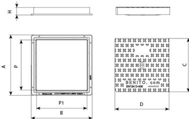
Hidráulica D4, für mittelmäßigen Verkehr geeignet. Ideal für einen durchschnittlichen täglichen Verkehr von 1.000 bis 20.000, Fahrbahnen, Fußgängerzonen, Seitenstreifen, und Parkplätze für alle Fahrzeugarten.
