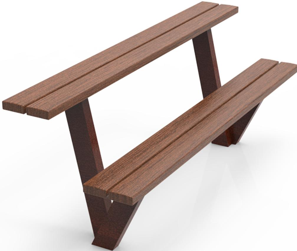
Sitzbank mit rohrförmigen Cortenstahlfüßen 50x100mm. Kieferholz-Bohlen 210 x 50 mm mit Autoklav-Hochdruckimprägnierung Schutzklasse IV gegen Insektenbefall. Verschraubungen aus Edelstahl
