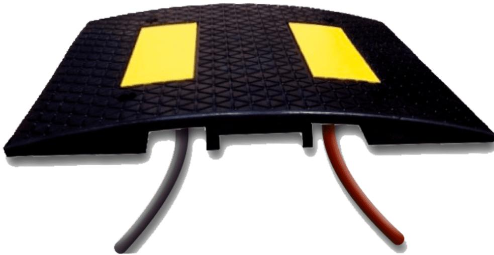
Kabeldurchführung aus 100% recyceltem und nachhaltigem Material. Modulare Einzelteile die zusammengefügt einen Geschwindigkeitsstopper ergeben. Aus natürlichem Kautschuk mit gelben und schwarzen Einsätzen, parallel zur Fahrtrichtung. Hohe Lichtreflexion und Rutschfestigkeit.
