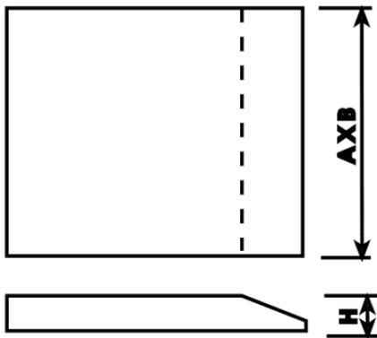
Dalles élastiques préfabriquées, système monocouche, à base de granulés de caoutchouc noir recyclé, pigments et résines polyuréthanes. Analysées et fabriquées conformément à la Norme européenne EN-1177 avec une absorption des impacts supérieure à 70 %.
