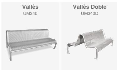
Banquette avec piètement en acier de Ø 40mm, siège et dossier en tôle d'acier perforée de 2mm d'épaisseur et trous de Ø 7mm avec traitement Ferrus, procédé qui protège le fer et garantit une résistance optimale à la corrosion.
